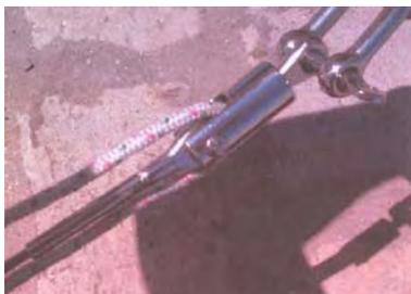
Intercaler l'émerillon entre la manille et l'embout à œil de l'étau. Ne pas oublier les rondelles de part et d'autre de l'embout à œil. Serrer très fortement la vis et pourquoi pas avec du frein filet. **Vérifier la rotation de l'émerillon et mettre du WD40 au niveau des billes.**
