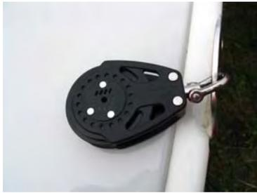
Installer les poulies winch sur les trous arrière de la cadène, manillon vers l'intérieur du bateau.
