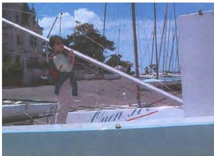
Lever le mât jusqu'à son positionnement dans l'étambrai, reposer l'étambrai et l'assurer en mettant les 4 piges.
