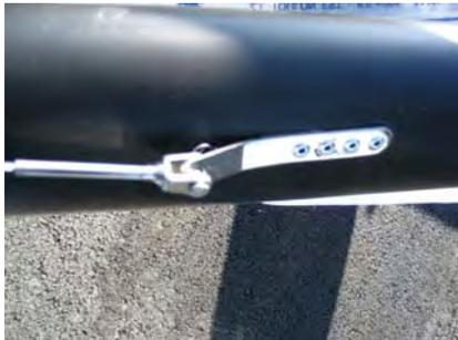
Fixation des câbles du losange sur le mât. Les ridoirs doivent être totalement détendus pour cette fixation.
