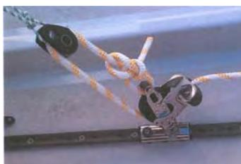
L'écoute de foc se fixe par un noeud de chaise sur le ringot de la poulie. Elle passe ensuite dans la poulie volante, puis dans la poulie ringot taquet en sortant par le taquet. Elle passe en continu sur l'autre bord, dans le taquet puis dans la poulie, ensuite dans la seconde poulie volante et retour au ringot par un noeud de chaise.
