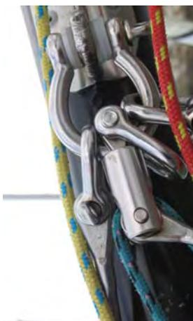
Fixer alors l'étau et les deux galhaubans sur la grosse manille du capelage du mât avec les manillons vers l'extérieur.
