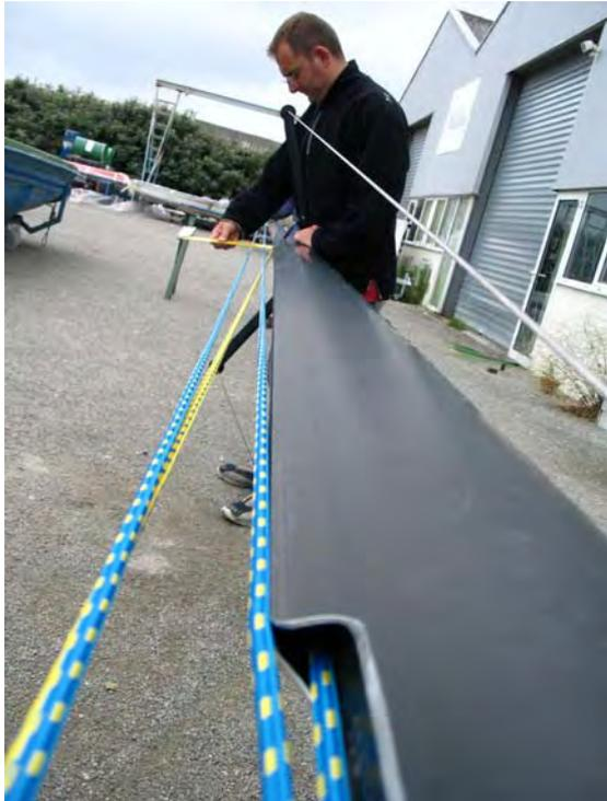
Puis une tension des câbles aboutissant à une flèche longitudinale du mât de 30 mm (voir photo).
