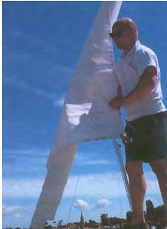
Enrouler le foc sur lui même à la main, dans le sens inverse des aiguilles d'une montre.
