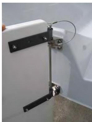
Les safrans se fixent sur les sur les fémelots à l'aide des axes inox ; ils sont assurés par des goupilles. Enfin, les barres de liaison sont fixées aux lames de safran par les articulations souples.
