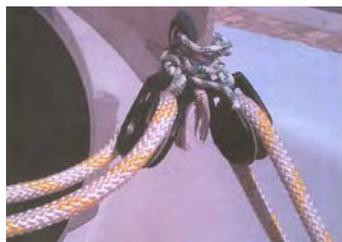
Les deux poulies volantes se brêlent sur l'oeillet de point d'écoute de foc avec les garcettes. Il est également possible de les brêler sur une manille que l'on fixera ensuite sur le foc.
