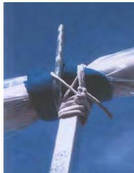
Le mât est posé sur tribord du bateau, à l'arrière sur le rail de GV, dans l'angle, protégé par une moquette (plusieurs épaisseurs) et fixé grâce à un sandow (un nœud de chaise, plusieurs passages, 3 demi clés pour finir et le surplus pour fixer le chariot). L'avant du mât est également fixé avec un sandow qui fait plusieurs tours et se bloque
