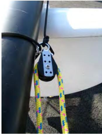
La drisse de spi part de la tourelle la plus grosse, passe dans un des réas de pied de mât puis dans un des trous de la bague d'étambrai, puis entre la barre de flèche et son réglage côté bâbord puis dans la poulie de capelage de spi, avant de redescendre vers la tête de spi.
