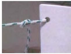
La quille doit être immobilisée pour le transport. Un bout est passé derrière la quille sous la coque et repris vers l'avant en faisant un petit palan. Puis un bout est passé sur le haut de la quille et souqué fermement après avoir glissé une moquette (4 épaisseurs) entre la quille et le puits de quille.
