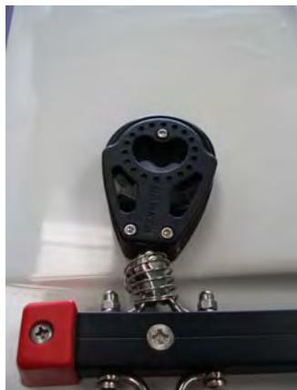
Installer les 2 poulies simples sur le pontet à l'extrémité de la barre d'écoute, en intercalant le ressort.
