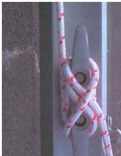
Fixer le palan de GV à la drisse de GV, poulie triple en haut. Hisser légèrement. Mettez la drisse au taquet de tournage en faisant impérativement un noeud de taquet.
